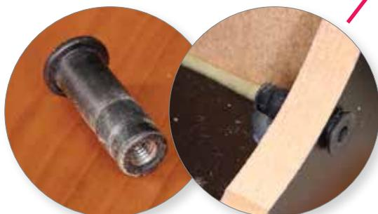
Il particolare sistema antivibrazioni di fissaggio è costituito da un cilindro in gomma con un dado che, se stretto, si espande. Sotto i condensatori sono posti elementi in silicone smorzanti
