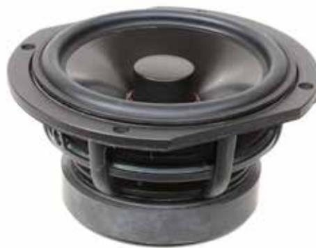
**Il midwoofer offre una nuova interpretazione del sistema a doppio cestello, anche se in versione semplificata. Il cestello esterno in alluminio pressofuso fa da sostegno al pesante gruppo magnetico, mentre l'equipaggio mobile, lo spider e la sospensione della membrana sono fissati a un piccolo telaio in plastica, a sua volta fissato con collante smorzante al magnete.**
